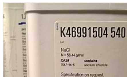
Ejemplo de inclusión del número CAS en un bote de cloruro sódico
