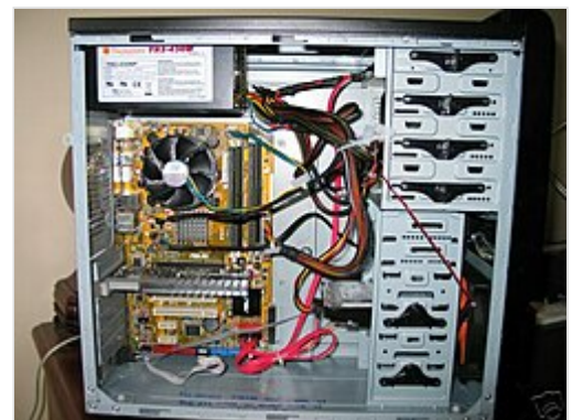
Caja de ordenador con un procesador LGA775 de Intel, con la tarjeta madre, el ventilador del procesador, la alimentación eléctrica, y la memoria.
