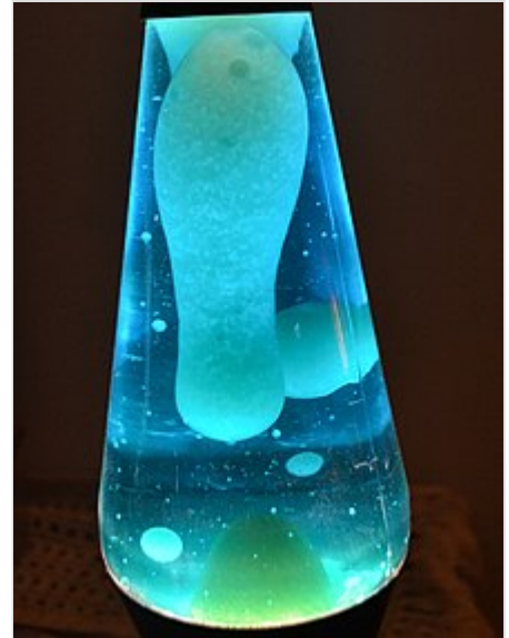
Una lámpara de lava contiene dos líquidos inmiscibles (una cera fundida y una solución acuosa) que agregan movimiento debido a la convección. Además de la superficie superior, también se forman superficies entre los líquidos, lo que requiere un interruptor de tensión para recombinar las gotas de cera en la parte inferior.
