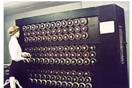
El Bombe replicaba la acción de varias máquinas Enigma .
