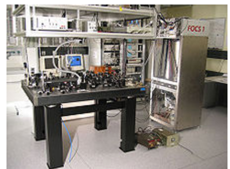
FOCS 1, reloj atómico en Suiza con un error de 10^{-15} , es decir, no más de un segundo en 30 millones de años
