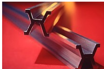
Patrones de medida del metro, utilizados de 1889 a 1960, compuestos de una aleación de platino e iridio .
