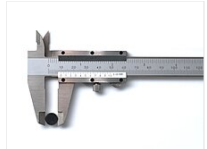
Medición (del diámetro) con un calibre.
