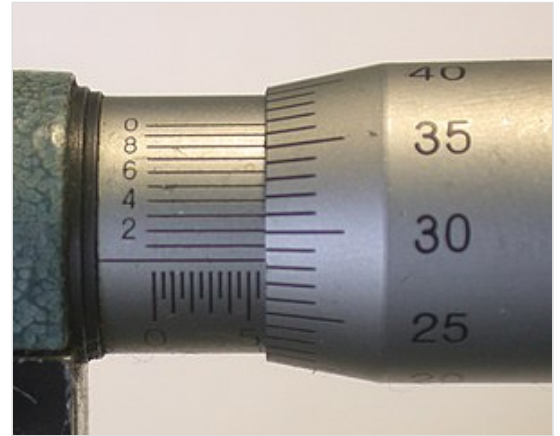
Nonio de un micrómetro, marcando la lectura 5,783 mm.
