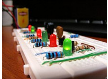
Circuito electrónico sobre una placa para prototipos o protoboard .
