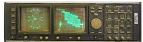
Barras de color EBU vistas en un MFO y un vectoscopio .
