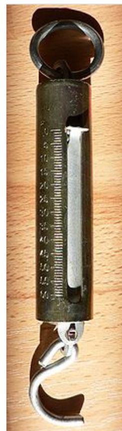
El dinamómetro sirve para medir el peso de los cuerpos
