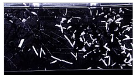
Algunos tipos de radiación ionizante pueden detectarse en una cámara de niebla .
